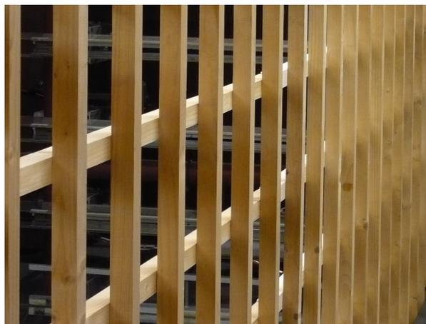
L'IAT dispose de **grilles de turbulence**, de différentes dimensions, qui permettent de créer des **conditions d'essais** plus proches de la réalité (intensités, échelles et spectres).
