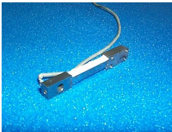
Chaque **balance** est **étalonnée** dans la salle de tarage où un **dispositif d'étalonnage** permet d'appliquer des efforts et des moments purs, avec reprise des efforts dus au montage. Ce banc permet d'accéder aux **interactions du 2ème**
