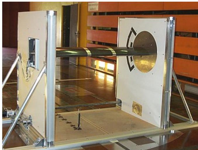
Le **banc oscillant aéroélastique** autorise un **mouvement de tangage ou de pompage forcé harmonique**, dédié à la **caractérisation aéroélastique de structures de l'aéronautique ou du génie civil**.
