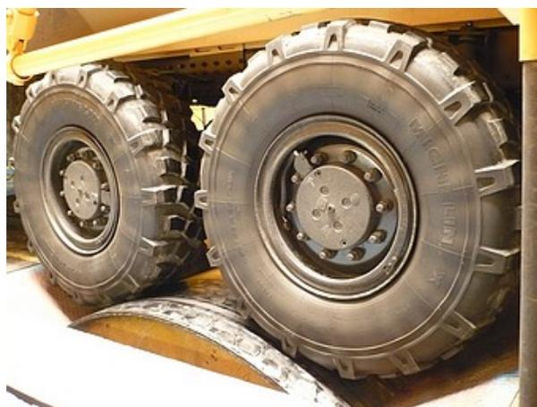
Ces **bancs à rouleaux** permettent de recréer les **conditions routières** et peuvent aussi être utilisés pour entraîner les roues de véhicules dans le but de mesurer le **refroidissement des freins**.
