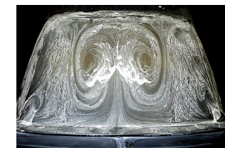
Tourbillons sur la vitre arrière d'une voiture
