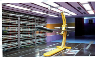
Mesure des efforts aérodynamiques sur un avion
